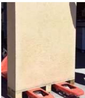
@ MATERR'UP Mur en Béton d'argile
