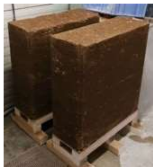
@ CEMEX Mur en Pisé
